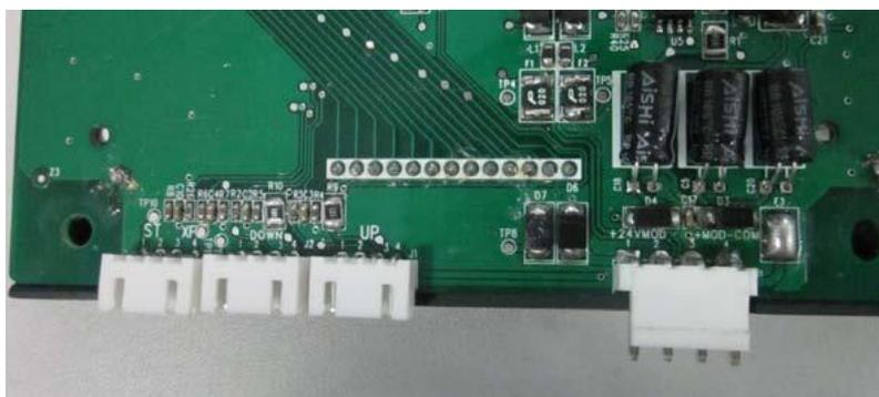
2) S1 设置楼层地址（0-56）：第一次按下按钮 S1，显示区域显示当前存储的楼层地址；以后没按下一次楼层按钮，楼层地址加 1，当长按按钮 2S 以上，楼层地址将快速递增。当楼层地址大于 56 时，将从 0 开始重新递增。
