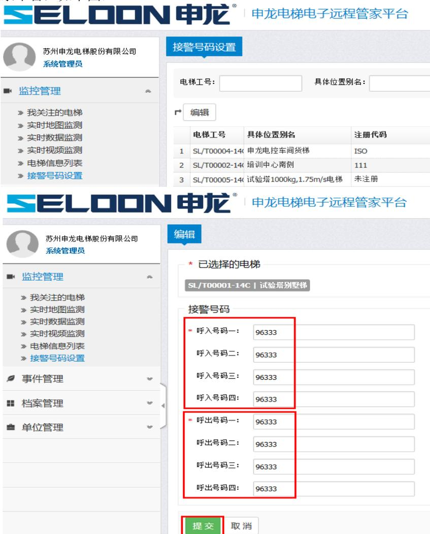
注：1.当电梯处于检修状态时，无法拨打所设置的号码；
