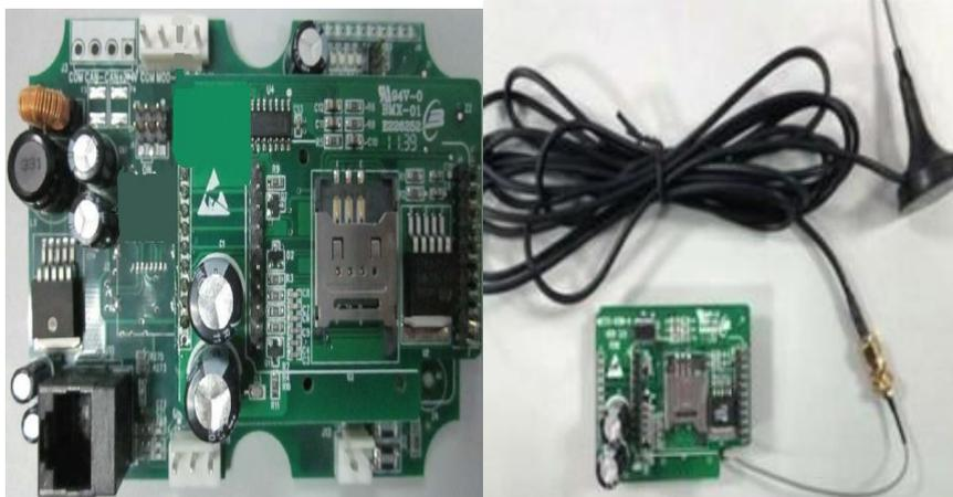
注：由于两者配合上没有防呆手段，需要注意插针的方向，请按上左图，两个板件产品名称方向一致才可（红色标准的名称方向一致才可）。
