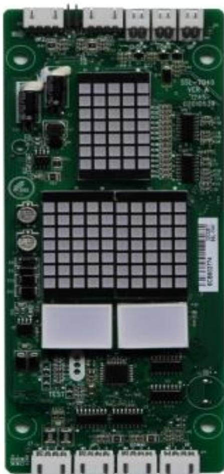
图 3-4 SSL-7040 显示板外观实物图
